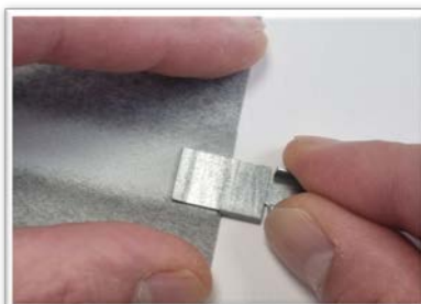
Klammer schräg aufschieben und gerade ausrichten
